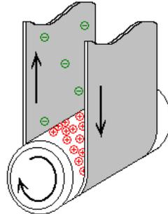
**Figura 5.6:** Dettaglio della parte inferiore del generatore di Van De Graaf: la carrucola ruotando si elettrizza per via del contatto con la cinghia
