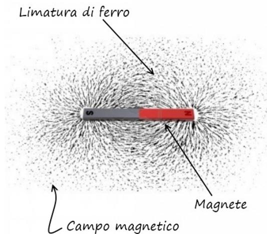
**Figura 4.2:** Questo magnete ha le caratteristiche di un magnete ideale: le linee di forza entrano da un polo ed escono dall’altro come indicato dalla disposizione della limatura di ferro
