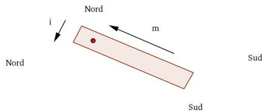
**Figura 4.12:** Prima fase di rotazione: Inizia la rotazione del rotore tramite repulsione magnetica tra i poli magnetici dei magneti, indicati ai lati dell'immagine, e i poli magnetici indotti sul rotore dal passaggio della corrente, indicati accanto all'immagine del rotore
