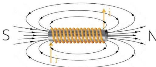
**Figura 4.4:** Magnetizzazione di un cilindro tramite un solenoide attraversato da corrente. Il solenoide è schematizzabile dunque con un magnete orientato a seconda della direzione della corrente secondo la "regola della mano destra"
