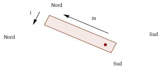
**Figura 4.14:** Seconda fase di rotazione: nonostante il pallino rosso sia ora in posizione opposta rispetto alla prima fase, la corrente scorre nello stesso verso e i poli rimangono invariati. Il motore continua in questo modo ad accelerare poichè si trova a contatto con il polo magnetico dello stesso tipo
