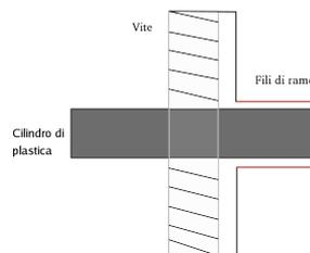
**Figura 4.7:** Rappresentazione grafica del rotore: sulla vite sono riportati gli avvolgimenti del cavo con un'orientazione differente da quella descritta sopra. In rosso, è riportata la sezione del filo da cui rimuovere la vernice isolante
