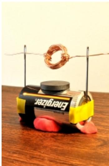
**Figura 4.5:** Motore monofase: la tensione di alimentazione è fornita dalla pila su cui è fissato il magnete. I supporti su cui ruota la spira sono spille metalliche da cucito
