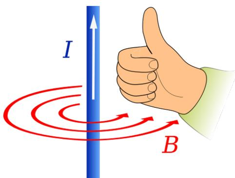
**Figura 3.1:** Campo magnetico generato da un filo attraversato da corrente  $I$  e funzionamento della regola della mano destra
