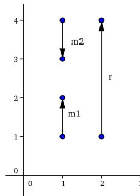
Ruotando il magnete  $m_2$  di un angolo pari a  $180^\circ$ , la descrizione vettoriale del sistema riportato nell'esempio precedente cambia nel modo seguente:
