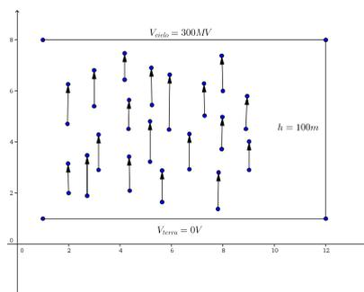
**Figura 5.5:** Situazione finale: la differenza di potenziale tra la nuvola e la superficie terrestre è maggiore o uguale del valore del potenziale richiesto dal valore della rigidità dielettrica. Si assiste al passaggio di corrente tra la nuvola e la superficie terrestre, ossia al fenomeno del fulmine
