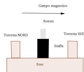
**Figura 4.10:** Rappresentazione grafica del motore magnetico bifase: le linee del campo magnetico vanno dal polo nord al polo sud
