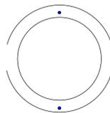
**Figura 4.8:** Rappresentazione grafica della sezione del commutatore: gli archi di circonferenza posti sul cilindro rappresentano le lastre metalliche applicate sul cilindro mentre i punti rappresentano i fili di rame da cui è stato rimosso lo smalto isolante
