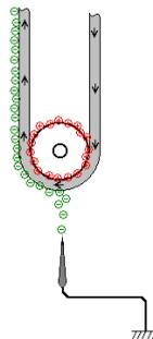
**Figura 5.7:** Dettaglio della parte inferiore del generatore di Van De Graaf: gli elettroni della spazzola sono attratti dalla campo elettrico generato dalla carica positiva accumulata sulla carrucola e vengono accumulati sulla superficie esterna della cinghia
