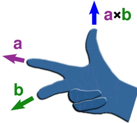
**Figura 3.2:** Funzionamento della regola della mano destra
