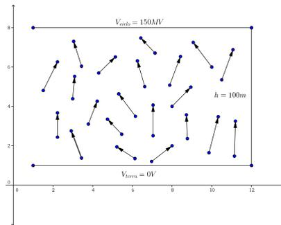
**Figura 5.4:** Situazione intermedia: Le molecole dipolari cominciano ad orientarsi lungo le linee del campo elettrico anche se ancora l'intensità del campo non eccede il valore della rigidità elettrica dell'aria
