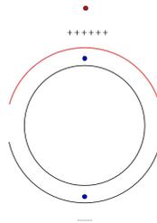
**Figura 4.11:** Prima fase di alimentazione sul connettore: la corrente scorre dal polo positivo e segue gli avvolgimenti del filo fino ad arrivare al polo negativo. La lastra di conduttore posta a potenziale positivo è colorata in rosso mentre quella negativa è colorata in nero
