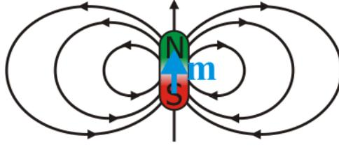
**Figura 4.1: Linee di forza del campo magnetico:** le linee del campo magnetico di una calamita sono uscenti dal polo nord ed entranti dal polo sud. In figura è riportato anche il vettore di magnetizzazione corrispondente al magnete raffigurato
