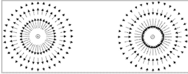
Figura 2.2: Linee di forza nel caso di carica puntiforme positiva (sinistra) e negativa (destra).
