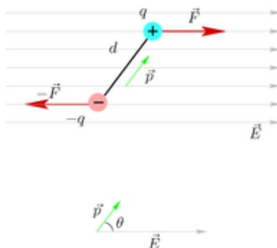
**Figura 5.2:** Dipolo in campo elettrico: se il dipolo non è allineato al campo, il momento delle forze genera una rotazione del sistema. In figura, il momento di dipolo è indicato con  $\vec{p}$  invece che con  $\vec{d}$
