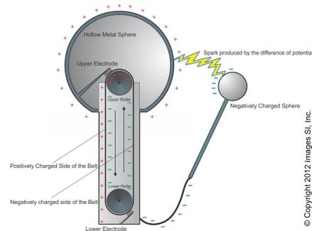
**Figura 5.8:** Il generatore di Van De Graaf. ATTENZIONE: nell'immagine raffigurata qua sopra, il conduttore superiore è carico positivamente, al contrario del nostro esempio. Ciò dipende, come detto precedentemente, dalla scelta dei materiali ma ciò non modifica i principi che stanno al base del funzionamento di tale generatore
