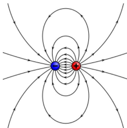
**Figura 5.1:** Linee di forza del campo elettrico di dipolo: le linee di forza escono dalla carica positiva (analoga al polo nord magnetico) ed entrano in quella negativa (analoga al polo sud)
