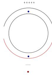
**Figura 4.13:** Seconda fase di alimentazione sul commutatore: la tensione positiva è a contatto con il conduttore nero, quella negativa sul conduttore rosso. I colori sono stati invertiti per indicare la commutazione della corrente. La corrente scorre in modo da allontanarsi dal pallino rosso nello stesso verso della prima fase
