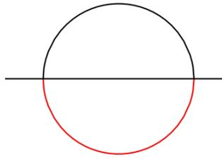
**Figura 4.6:** Sezione del cavo: la parte nera (sopra la retta) mantiene la vernice isolante mentre in corrispondenza della parte rossa (sotto la retta) la vernice viene rimossa
